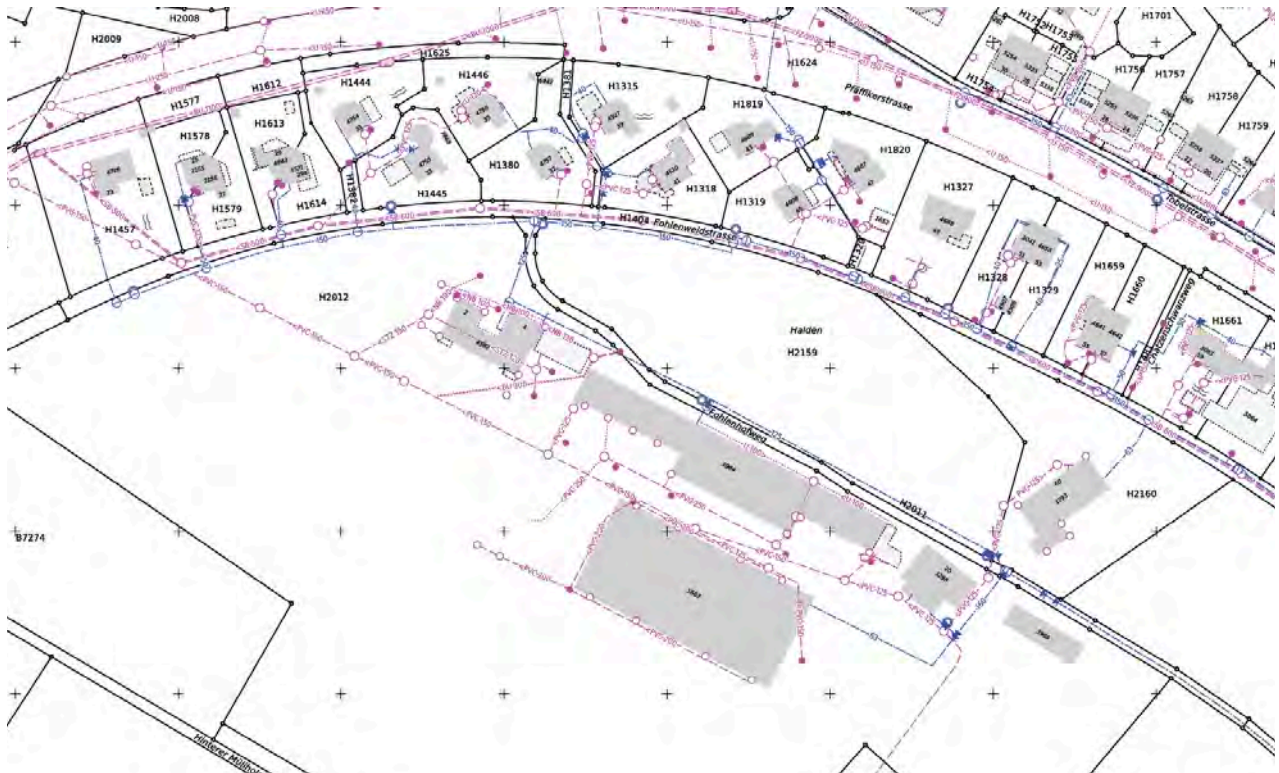
Ausschnitt Werkleitungskataster, 30.7.2018 (blau: Wasserversorgung / violett: Entwässerung)
