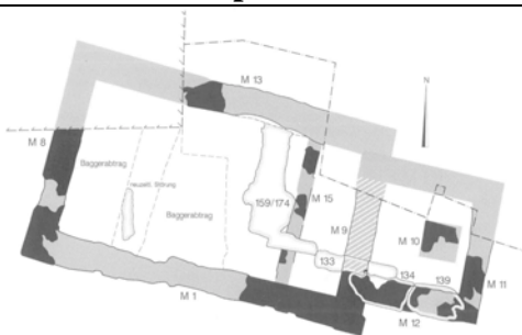
Abb. 12. Kapelle mit allen aufgedeckten Mauern sowie neuzeitlichen Störungen. Mauer schwarz = Mauer nachgewiesen; gepunktet mit Begrenzungslinie = Mauergrube nachgewiesen; gepunktet = Mauer ergänzt. 133, 134, 139, 159, 174 neuzeitliche Störungen (Grabungsschnitte F. Kellerer?); M. 1:150.
